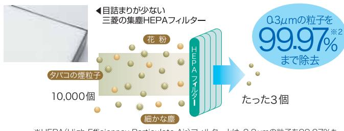
※HEPA(High Efficiency Particulate Air)フィルターとは、0.3μmの粒子を99.97%も除去する能力をもつ高性能・高効率フィルターの総称で、半導体工場のクリーンルームなど極めて高い清浄性が求められるところで使用されています。
