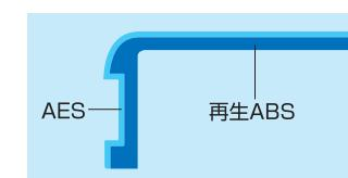
剛性・硬度・加工性・耐衝撃性・曲げ耐疲労性に優れた再生ABS樹脂を使用したベンチです。
